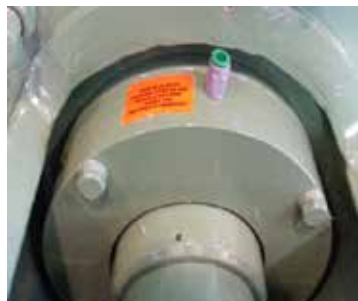
Speciální patentované hřídelové těsnění
