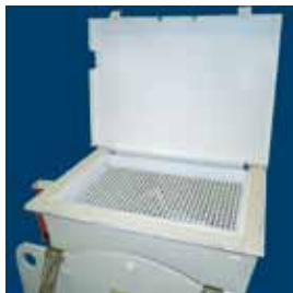
Inspection hatch with grille for manual material addition Inspektionsklappe mit Schutzgitter zur manuellen Produktzugabe Inspekční otvor s mřížkou pro ruční plnění Portello d'ispezione con griglia per carico manuale
