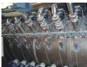
Mixéry, vstříkávání kapaliny, tepelný plášť
